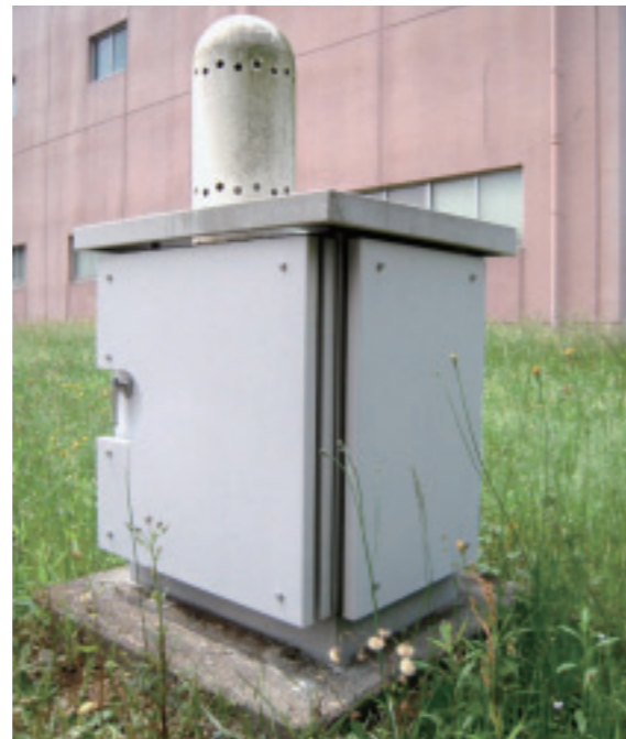
写真 1 アイソトープ総合センター敷地内に設置されたモニタリングポスト。先端部分に NaI (TI) シンチレーション検出器が内蔵されていて周辺のガンマ線による放射線量率を測定している。
