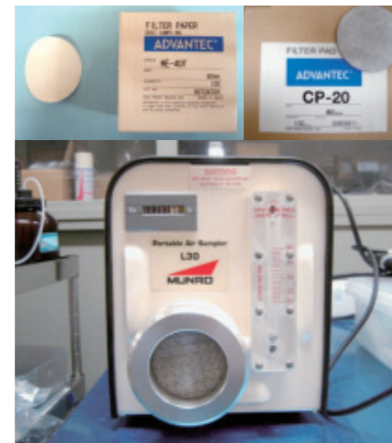
写真 2 ローボリュームのエアサンプラーとダストを捕集する 2 種類のフィルター。
