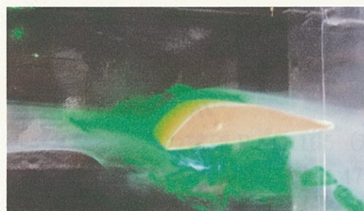
(翼周りの空気の流れを可視化する実験 : 翼型ブレード)
