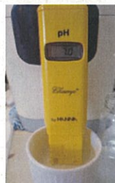
図4) 標準水(精製水)につけたpH測定機器
