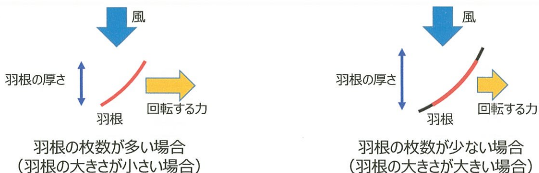
図18 羽根の大きさと回転する力
