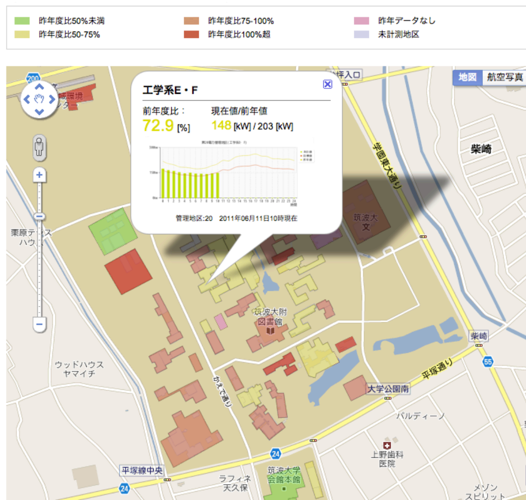
図. 地図情報システム (Google Maps) と電力使用量の連携: 電力管理地区毎現在値, 昨年度値, 削減目標値のグラフ表示とともに, 前年度比により建物を色分けし, 地図上に提示するシステム. 1時間毎に自動更新.
