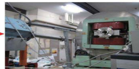
9階 地震横揺れによるイオン源装置の損壊 (真空排気装置は全損)
