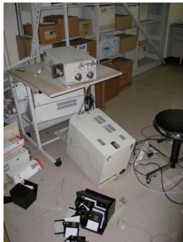
高速液体クロマトグラフィーが倒壊・破損
