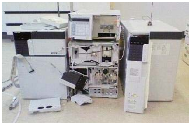
GPC装置光学部品損傷
