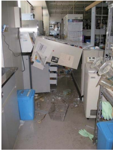
試薬棚が倒れ、遠心機を直撃・損壊
