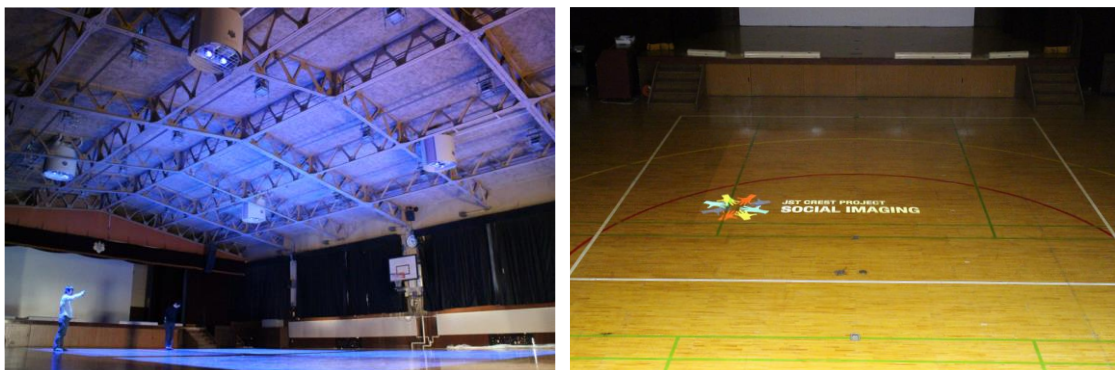
(左)体育館に設置された大型床面投影プロジェクタ (右)プロジェクタの投影例
