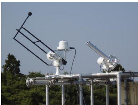
図2 直達放射（右）と散乱放射（左）を測定している分光放射計。直達放射は筒をつけて太陽の方向からの日射だけを測定する。散乱放射は太陽の方向を黒い球で隠して測定する。いずれも、太陽追尾装置に取り付けられている。
