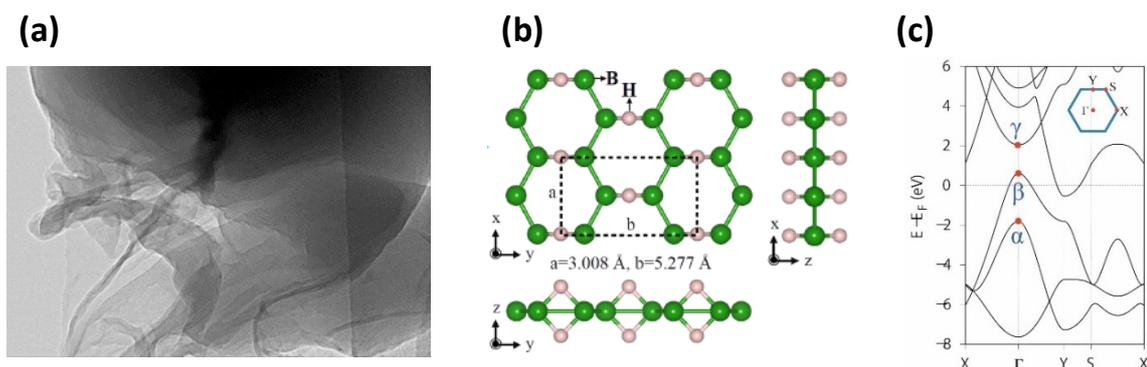
図2 ホウ化水素シートの透過型電子顕微鏡写真(a)、結晶構造(b)、電子構造(c)
