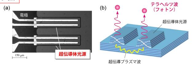
図説 (a) 基板上に作製した2つの超伝導体光源の顕微鏡写真。図中の電極から光源に電流を注入するとテラヘルツ波(フォトン)が放射される。(b) 同期した2つの超伝導体光源の概念図。隣り合う光源が超伝導プラズマ波を介して結合することで、高強度で位相のそろったフォトンが放射される。
