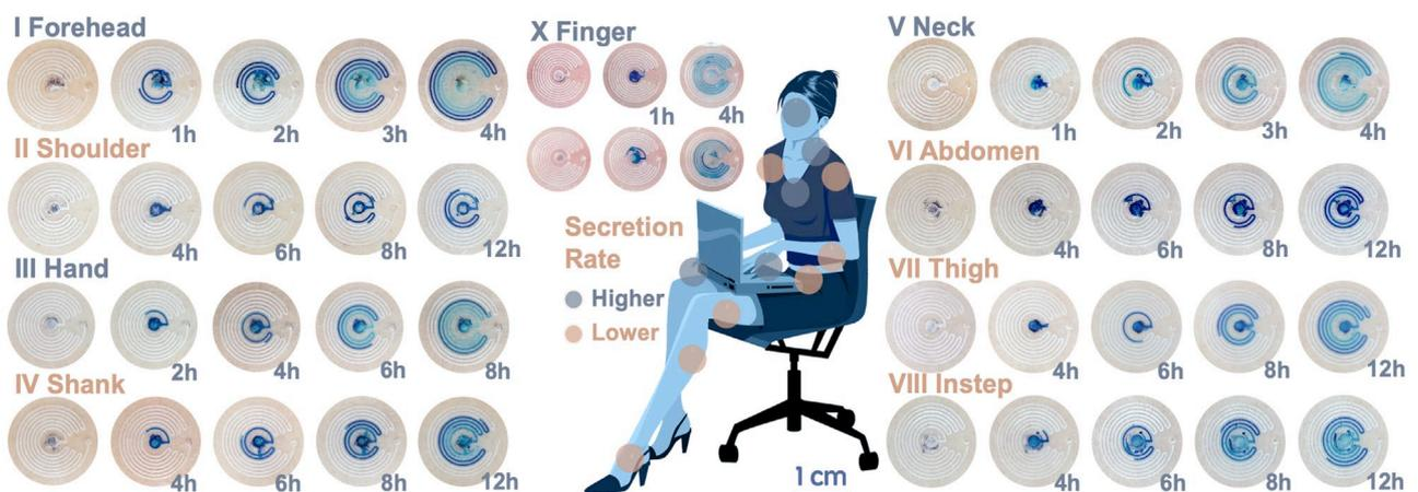
図 2 ヒトの発汗量を被験者のさまざまな部位にパッチを張り付けて測定した様子。食用色素が汗の流路の入り口に置かれており、補足された汗が流路を進むにつれて、モニタリング開始後からの発汗量を青色(食用色素の色)で可視化できる。これを経時的に観察することで発汗速度を評価する。
